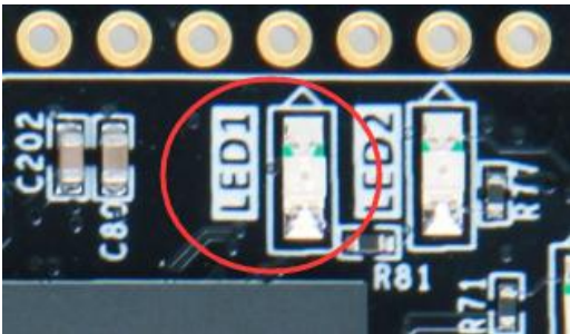
图 6-15 PS 的 LED 灯实物图
